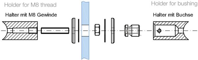
Paarweise Griffbefestigung an Glastüren. Durchgangsbohrung Ø 16 mm
